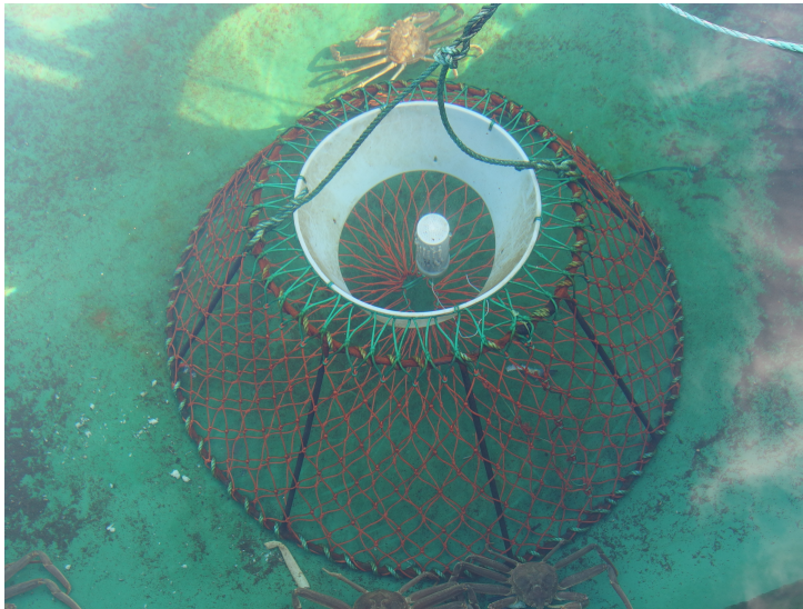
Figur 6: En mye brukt teine til snøkrabbefiske. Teinen består av en ramme i svart-/galvanisert stål, og nettet er produsert i PE(polyetylen) og har 70 mm maskestørrelse (egenfotografert).
