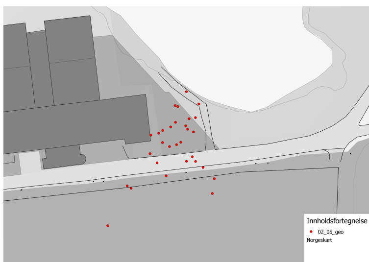
Figur 6.3: Innendørs innsamling av romlige data med GNSS-mottaker i mobiltelefon
