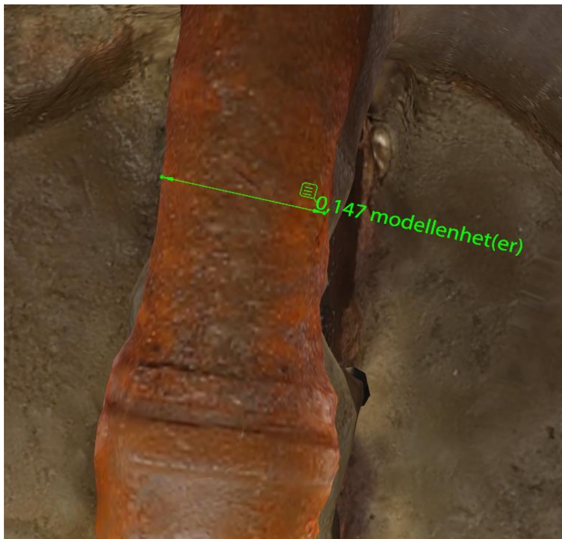
Figur 4.2: Figuren viser målt dimensjon til en vannledning.
