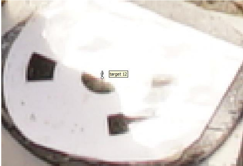
Figur 3.8: Figuren viser hvordan ujevnt lys på et target har gjort at PhotoScan ikke har klart å finne senter.
