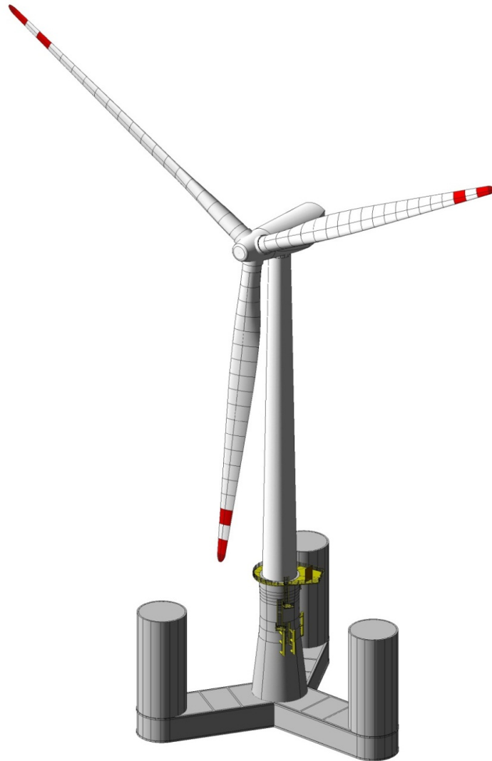
Figur 1-3 Den halvt nedsøkkbare vindturbinen OO-Star Wind Floater med turbin, turbintårn, sentsøyle, pongtongar og bøtter (Dr. techn. Olav Olsen 2015)
