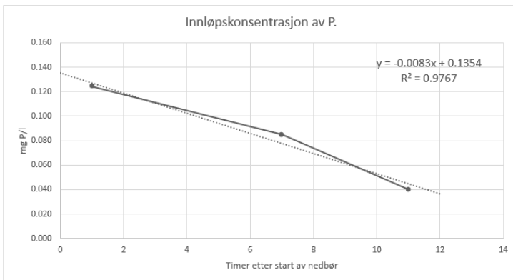
Figur 9: Sammenstilling av kurvetilpasset verdier for innløp til kolonnene og faktiske analyserte konsentrasjoner av tog-P fra innløpet.
