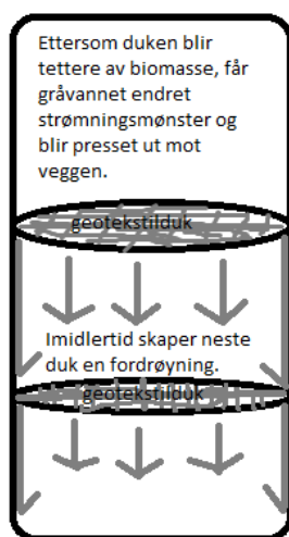
Figur 28: Skisse av antatt strømningsmønster for kolonner med multiple geotekstilduker.
