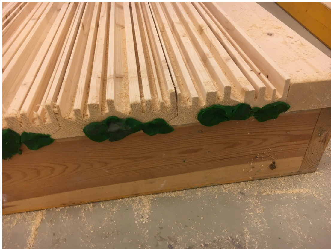
Figur 15 Testobjekt 4, tverrsnitt med plastelina for å tette hull
