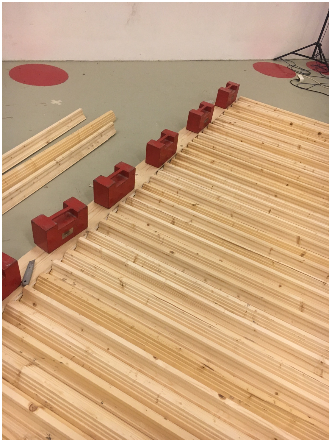
Figur 14 Testobjekt 3 med planke i den ene enden for å tette hull
