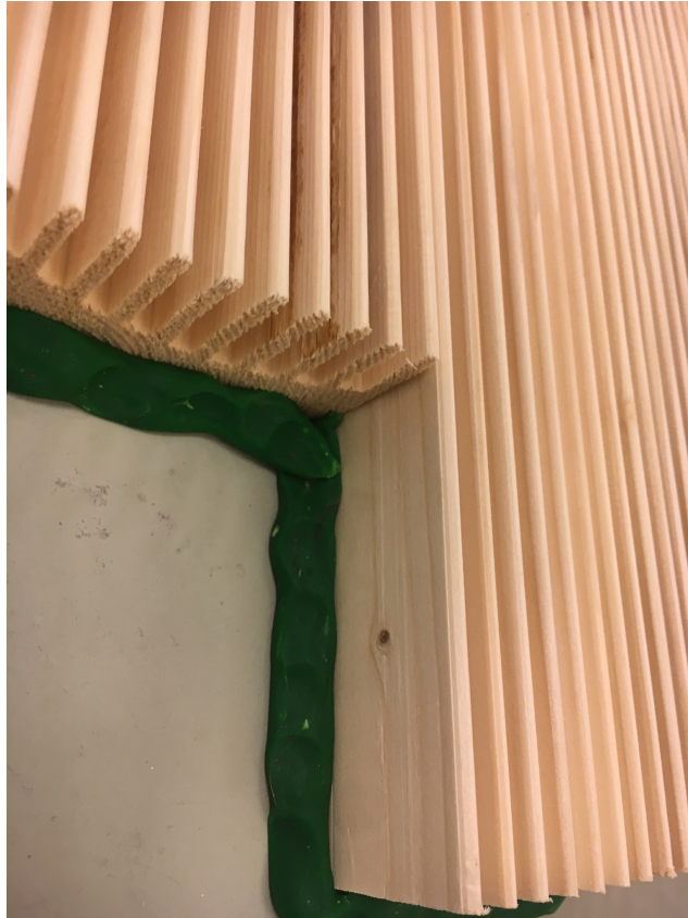
Figur 11 Testobjekt 1 med plastelina for å tette hull
