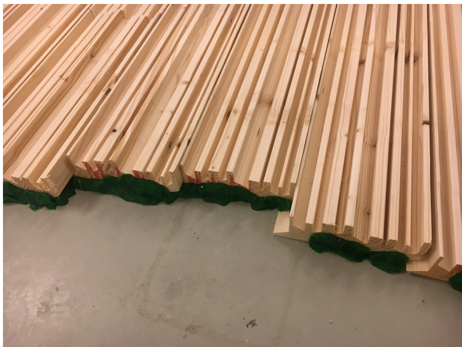
Figur 13 Testobjekt 2 med plastelina for å tette hull
