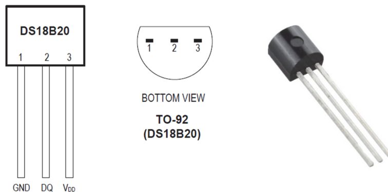
Figur 4.4: Illustrasjon av DS18B20 temperatursensor fra Maxim Integrated (2008). Hver sensor har tilkoblingspunkt for henholdsvis jord (GND), data (DQ) og ekstern strømtilførsel ( V_{DD} ). Hver sensor har et unikt digitalt serienummer som muliggjør tilkobling av flere sensorer i samme krets.
