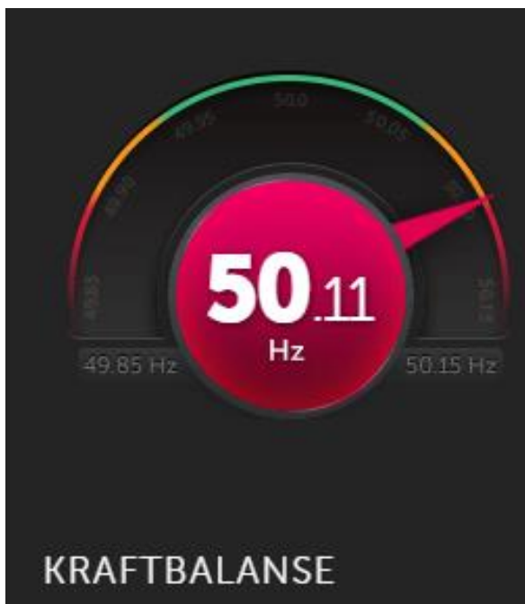
Figur 1: Bidet viser frekvensen den 7. mars klokken 11:26 [6]. Frekvensen er i dette øyeblikket 50,11 Hz og utenfor det tillatte frekvensbånd, derfor den røde fargen.
