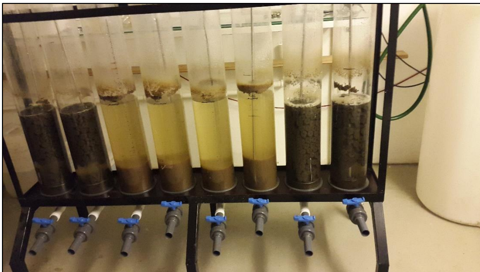
Figur 22: Forsøksreaktorene; fire aktivslam-reaktorer (i midten) og fire MBBR-reaktorer (to på hver side). Luft ble ført inn gjennom slanger i toppen av reaktorene, og videre gjennom diffusoren som tilførte luft til reaktorene fra bunn og opp. Reaktorene hadde tappekraner i bunn, men prøvene ble tatt ut fra toppen på grunn av praktiske hensyn. Foto: Kristin S. Tindlund.
