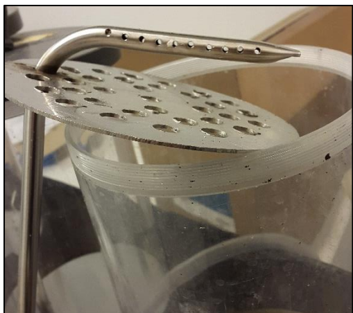
Figur 23: Luftdiffusor for luftfordeling i reaktorene. I MBBR-reaktorene var diffusoren tilpasset med en perforert plate i bunn, slik at luften ble bedre fordelt for å sikre god omrøring. For aktivslam-reaktorene så luftdiffusoren lik ut som den på bildet, med unntak av den perforerte platen. Foto: Kristin S. Tindlund.
