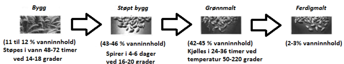
Figur 2.6 viser flytskjema av maltingsprosessen og forskjell i vanninnholdet (Bamforth, 2003)
