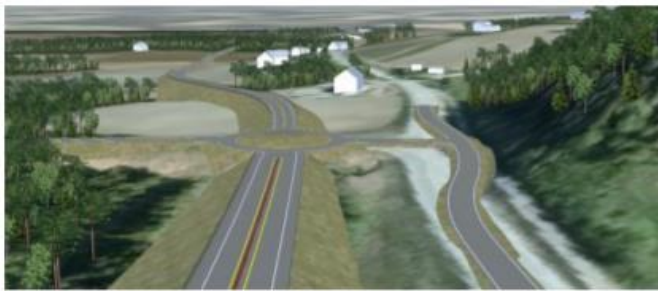
Figur 17. (Figur til venstre) Alternativ A3 sett nordover fra Asphaugen. Ny trase for E6 til venstre og lokalveg til høyre (Statens vegvesen 2013a).
