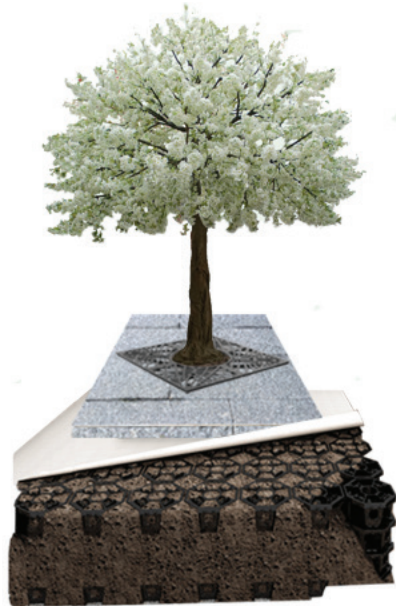
Figur 119 Illustrasjonen viser hvordan trærne skal anlegges med celledøsning. Deler av illustrasjonen er hentet fra; Gooden(2016)
