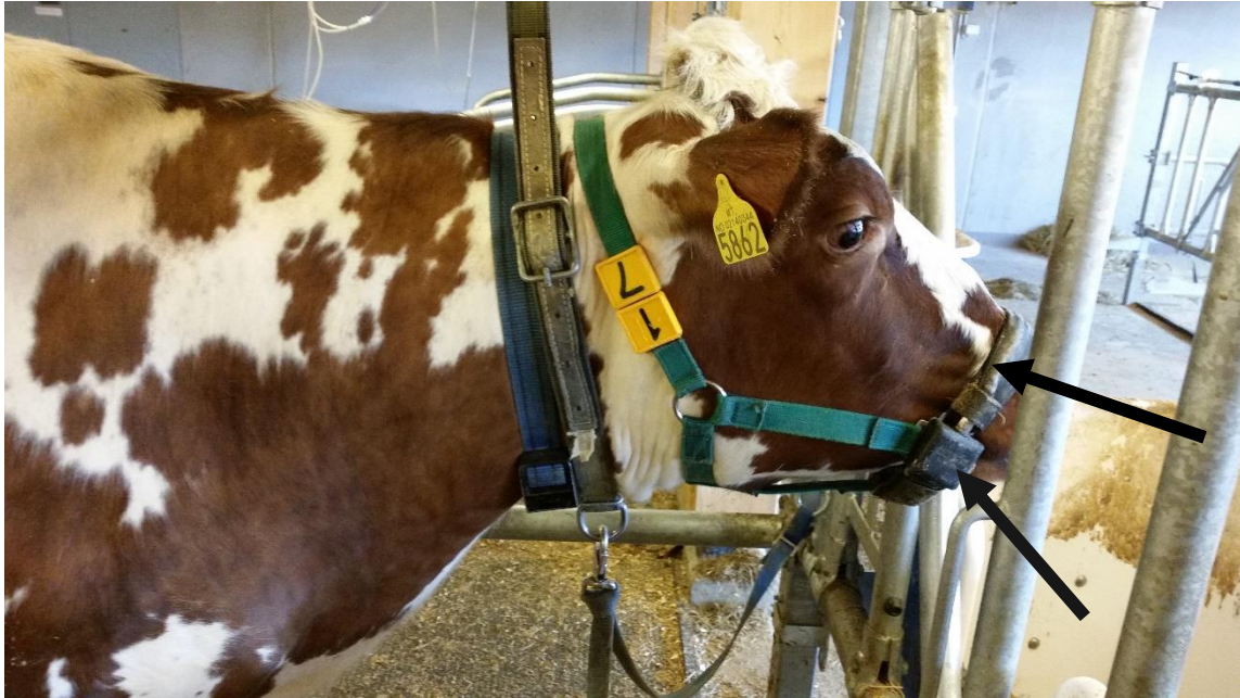
Figur 9: Grime med nesebandsensor i bruk. Den øverste pila viser sensoren som registrerer hvilken tyggeaktivitet kua har. Den nederste pilen viser boksen som registreringene blir lagret i. Det sitter en slik boks på andre siden som inneholder batteriet. (Foto Camilla T. Skjelbred).
