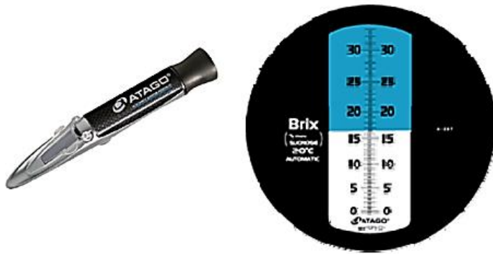
Bilde 2: Et optisk refraktometer og avlesningsskalaen hvor man ser er klar overgang mellom mørkt og lyst område (Heinrichs & Jones, 2011).
