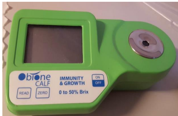
Bilde 5: Refraktometeret av modellen MA882 som ble benyttet under forsøket.
