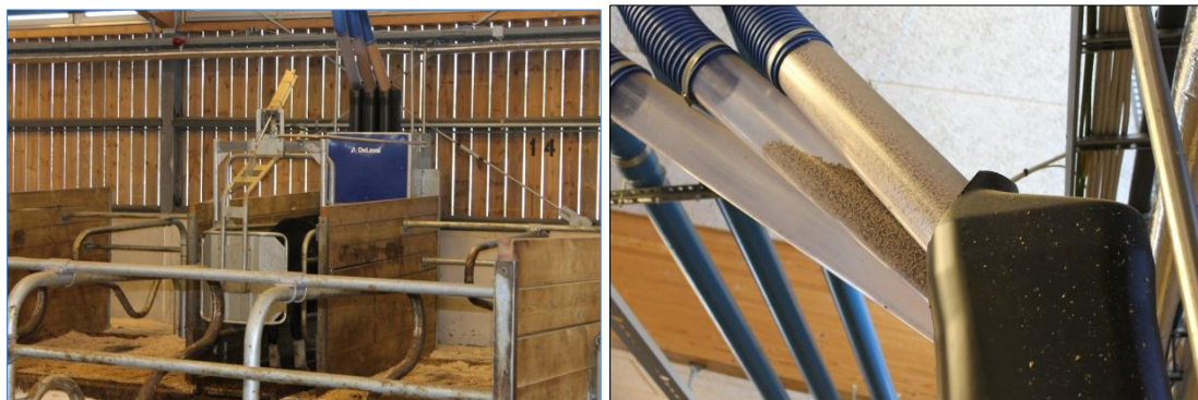
Figur 5 Bilde t.v. Kraftfôrautomaten lukker lemmen når et individ er inne for tildeling. T.h. Her kommer de 2 ulike kraftfôrene ned i 2 ulike rør
