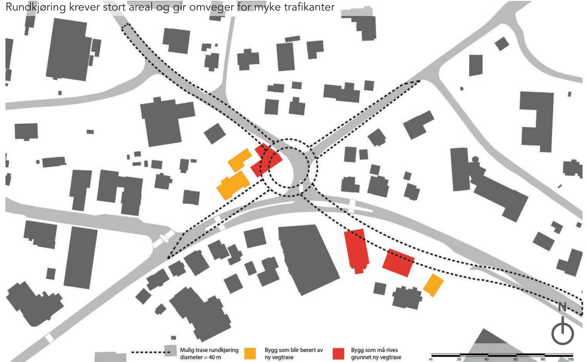
Fig. 4.016. Figuren viser arealbehovet for en rundkjøring med 40m diameter i krysset mellom Tonganevegen og E134. En rundkjøring vil gi omveger for myke trafikkanter og flere bygg må rives. Skissen viser en av flere mulige løsninger for rundkjøring i krysset.
