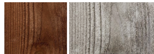
Figur 4.29: Kebony treverk - ved produksjonstidspunkt og etter noen år i vær og vind uten overflatebehandling.
