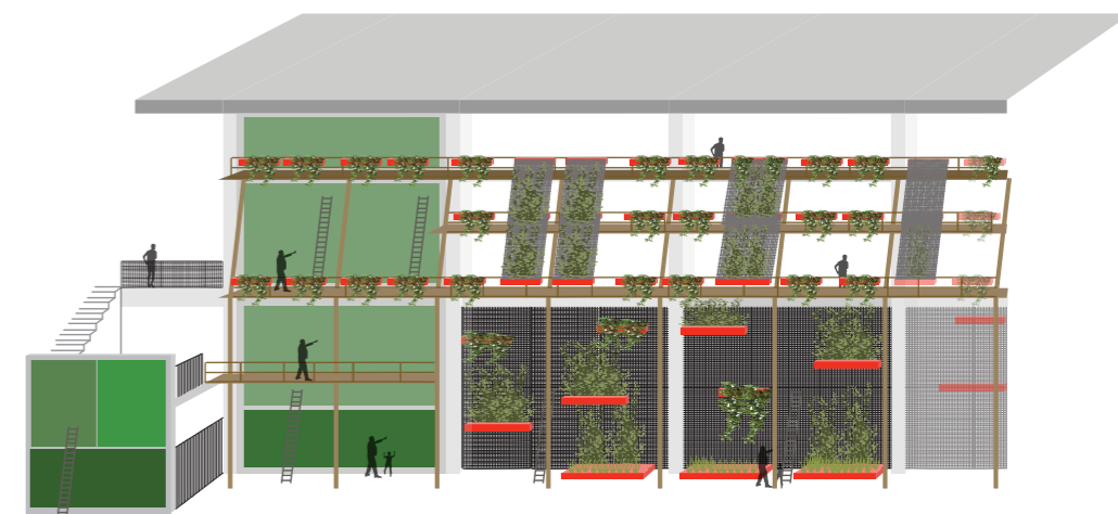
Figur 4.55: Illustrativ fremstilling av konstruksjonen, som knytter jerngitter- og betongfasadene sammen til en helhet.
