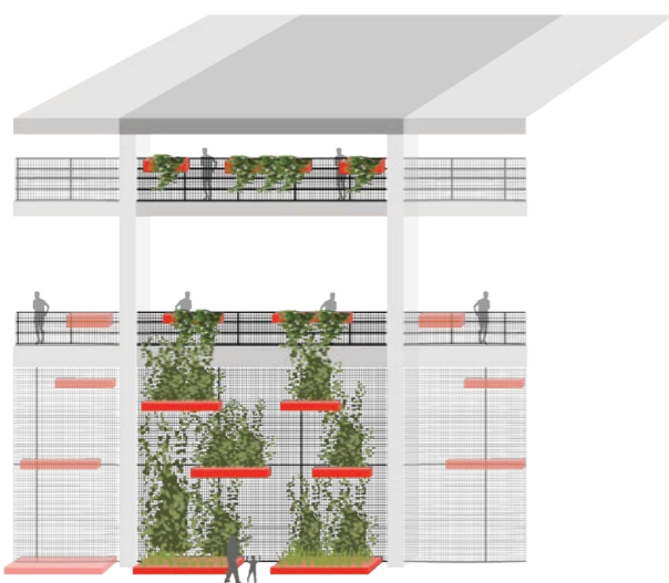
Figur 4.23: Illustrativ fremstilling av plantekassenes formmessige uttrykk på jerngitterfasaden.
