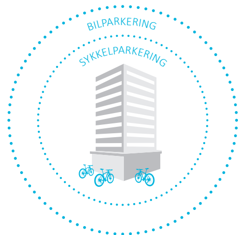
Fig. 55: Diagrammatisk fremstilling som viser at sykkelparkering bør prioriteres- og legges nærmere målpunktet enn bilparkeringen.
