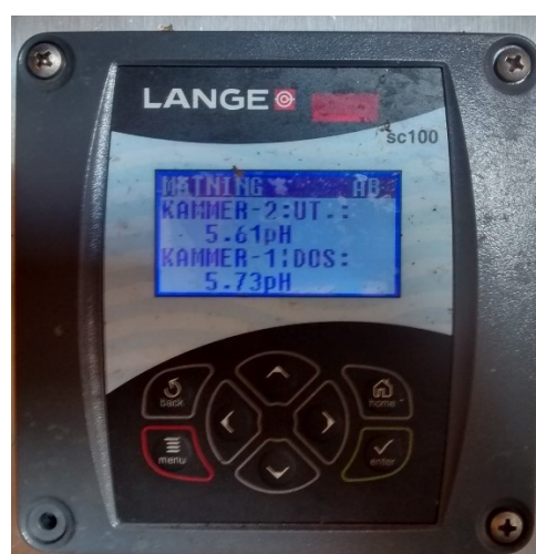
Figur 20: pH-verdier fra pH-transmittere i blandekammeret, apparatet er levert av LANGE
