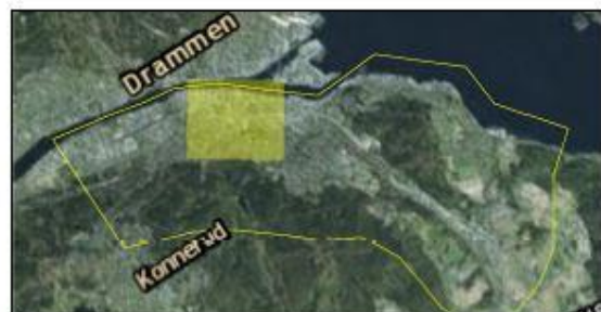
Figur 7-2 Oversvømmelsesanalyse av Strømsø, Drammen med følgende variabler: maksimal ruhet og ingen infiltrasjon. Resultatene viser omfattende oversvømmelser med vanddybder inntil 1 m. Områdene rundt Marienlyst og Bjørnstjerne Bjørnsons gate er hardest rammet. Kunstgressbanen på Marienlyst er oversvømt med vanddybde cirka 0,25 m.
