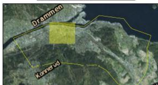
Figur 7-17 Hastighetsanalyse av Strømsø, Drammen med følgende variabler: konstant ruhet ( M=14 ) og maksimal infiltrasjon. Vannhastigheter over 0,5 m/s er begrenset til drenslinjene.
