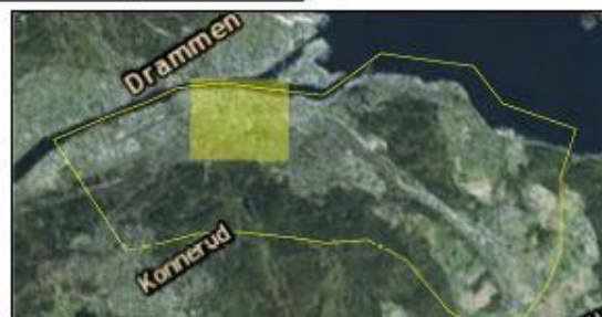
Figur 7-11 Drenslinjeanalyse av Strømsø, Drammen med følgende variabler: maksimal ruhet og maksimal infiltrasjon. Drenslinjene er i dette scenarioet redusert til at de nesten ikke er synlige. Vannføringen er stort sett under 100 l/s.
