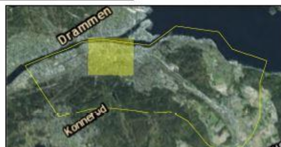
Figur 7-4 Oversvømmelsesanalyse av Strømsø, Drammen med følgende variabler: maksimal ruhet og maksimal infiltrasjon. Svært lite oversvømmelser. Et mindre område ved Bjørnstjerne Bjørnsons gate er oversvømt med vanddybder inntil 0,25 m. Kunstgressbanen på Marienlyst er ikke oversvømt
