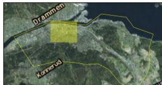
Figur 7-15 Hastighetsanalyse av Strømsø, Drammen med følgende variabler: minimal ruhet og ingen infiltrasjon. Det er vannhastigheter 2 til 5 m/s langs flere strekninger. De høyeste vannhastighetene befinner seg der de største drenslinjene går. Det er spesielt høye hastigheter i øverst i åsen i sydvest.
