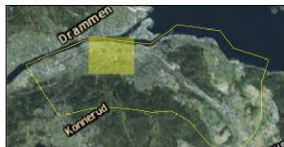
Figur 7-1 Oversvømmelsesanalyse av Strømsø, Drammen med følgende variabler: minimal ruhet og ingen infiltrasjon. Resultatene viser omfattende oversvømmelser med vanddybder inntil 1 m. Områdene rundt Marienlyst og Bjørnstjerne Bjørnsons gate er hardest rammet. Kunstgressbanen på Marienlyst er oversvømt med vanddybde mellom 0,25 og 0,5 m.
