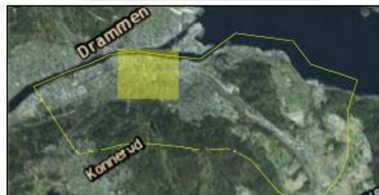
Figur 7-3 Oversvømmelsesanalyse av Strømsø, Drammen med følgende variabler: konstant ruhet ( M=14 ) og maksimal infiltrasjon. Spredte oversvømmelser med liten vannddybde. Kunstgressbanen er oversvømt med vannddybde 0,05-0,15 m.
