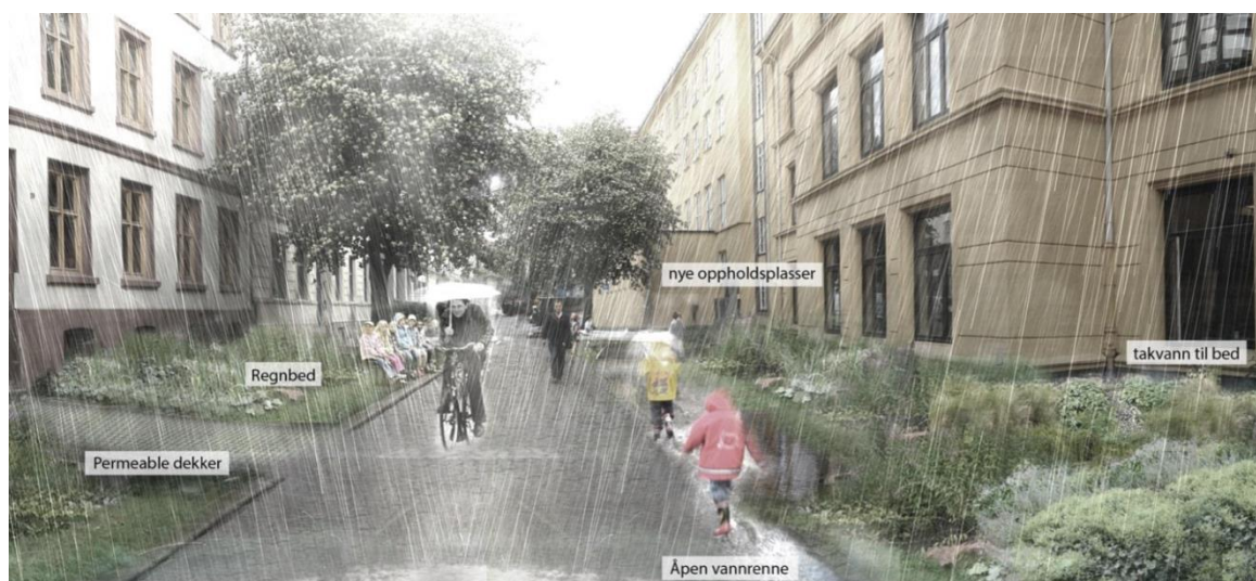
Figur 3-2 Eksempler på tiltak for lokal overvannshåndtering med hensikt å infiltrere, forsinke og fordrøye regnvannet kan være vegetasjon, grønne tak, regnbed og permeable flater (Braskerud, 2015).
