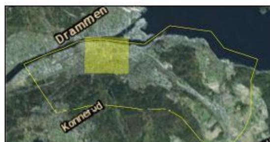
Figur 7-16 Hastighetsanalyse av Strømsø, Drammen med følgende variabler: maksimal ruhet og ingen infiltrasjon. Vannhastighetene er tydelig reduserte, spesielt øverst i åsen i sydvest. Det er fortsatt høye vannhastigheter langs drenslinjene ned til Strømsø.
