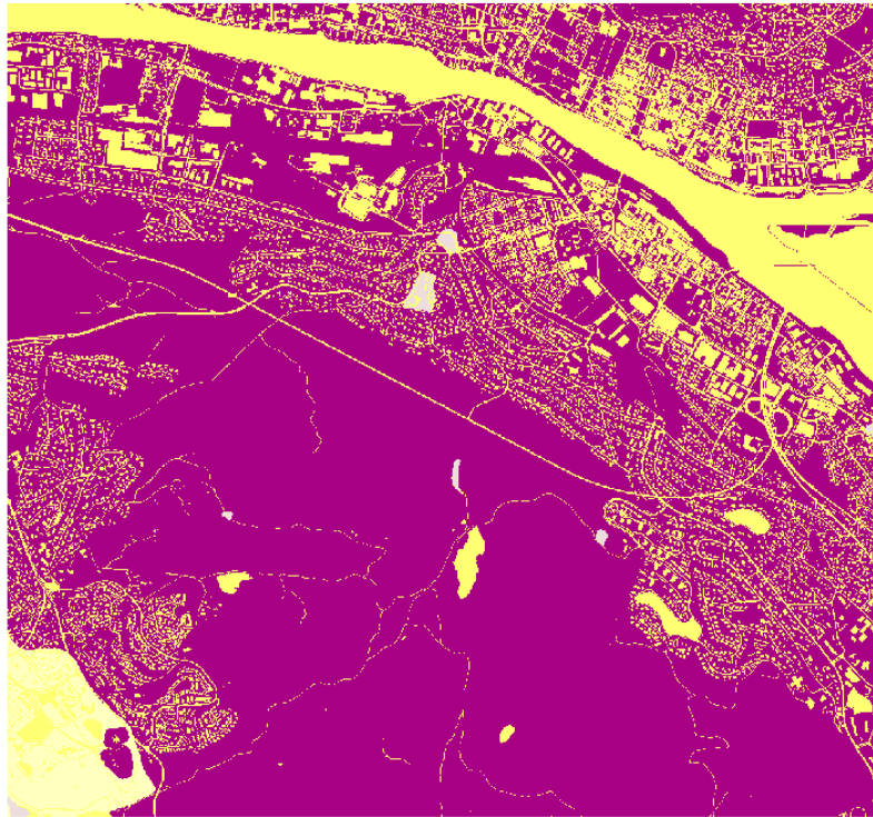
Figur 6-19 Kartraster for infiltrasjon der hver farge har egen infiltrasjonsrate. Det mørkerosa området markerer infiltrasjonsevnen i fyllmasser, bart fjell og havavsetninger. Det gule området markerer veger og bygninger. De mindre områdene i grått og lysegult markerer strandavsetninger og elveavsetninger (Skjermdump).
