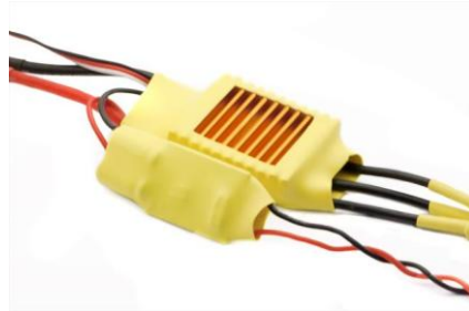
Figur 48: Motorkontroller fra Power Pro [1].
