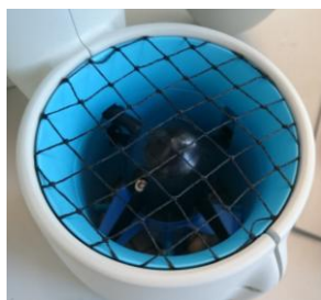
Figur 35: Dagens løsning på dysebeskyttelse (Eget foto).
