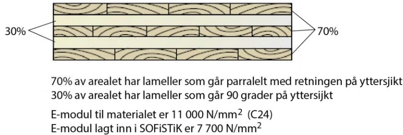
Figur 3.4 Forenkling av E-modul lagt inn i Sofistik
