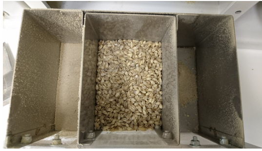
Figur 8. Separert fraksjonsmateriale i metallboks i kornsliper: slipte korn i midten, og avslipt fraksjon til venstre og høyre. Foto: A. Radecki.
