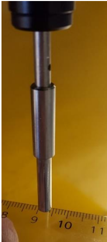
Figur 16: Den sylindriske proben på teksturmåleren, 4 mm i diameter (Foto: Elisabeth Lysø)
