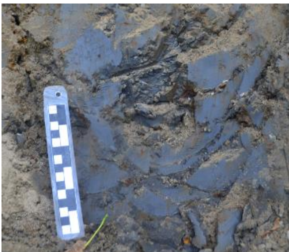
Figur 4.27: Viser massivt lag med blålig siltig leire.
