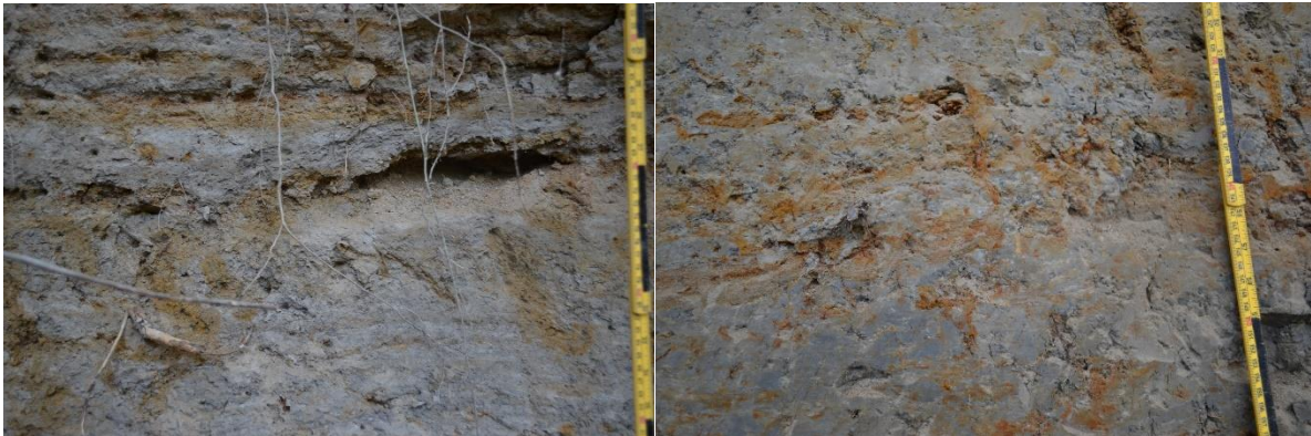
Figur 4.25: Viser laget med grovere lettpakket fraksjon (5 cm), med rødlige linjer som følge av rotsystem.
