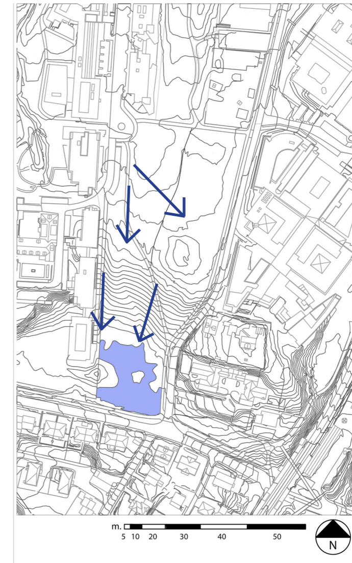
Kart 16: Pilene viser vannets fallretning på området. Blå markering viser hvor vannet står høyt i grunnen under jordprøvetaking
