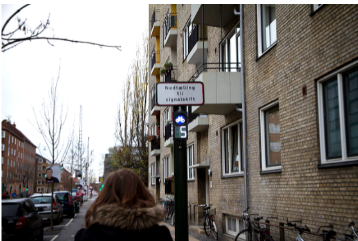
Bilde 2: Nedtellingssignal i forkant av kryss som angir ventetiden til grønt lys i Frederiksberg, Danmark (Colville-Andersen 2013).
