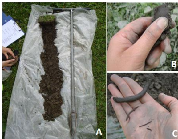
Figur 11: Jordprofil tatt ut med en jordbor for skjønnsmessig bedømmelse av kornfordeling i felt (A). Å lage bånd eller rulle «pølser» av jorda (B og C) er metoder som kan gi en indikasjon på jordart og innhold av finstoff (leire og silt). Siltig lettleire er det mulig å klemme ut i bånd. Et bånd lages ved å skyve jordprøven oppover med tommelen, mot pekefingeren. Båndet skal peke oppover slik at det brykker på grunn av egen tyngde. Bredde og tykkelse skal være jevn. Hvor langt båndet blir før det brykker, avhenger av jordart.
