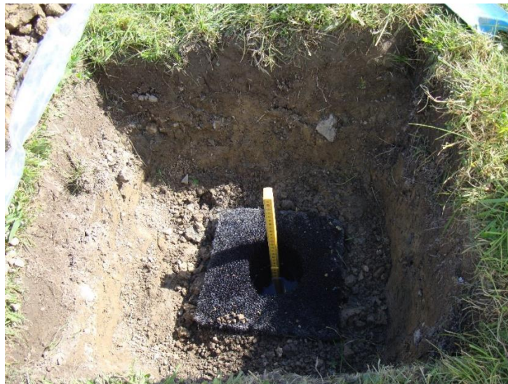
Figur 18: Grop-infiltrasjon i en grop på 25*25 cm i 60 cm dyp.
