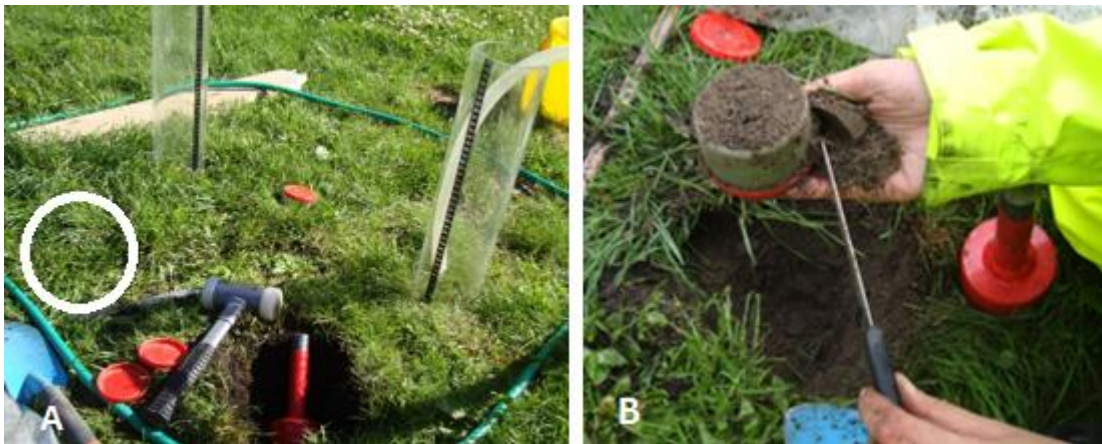
Figur 26: Uttak av pF-ring før gjennomføring av MPD-forsøk (hvit ring). Etter forsøket tas det ut pF-ring fra der MPD-infiltrometeret har stått. Før pF-ringen bankes ned i jorda plasseres det røde hammerhodet på ringen, for å unngå komprimering av jorda ved hamring (A). pF-ringen må fylles helt med jord (B). En kniv brukes for å skjære av overflødig jord, før lokk settes på for å unngå fordampning av vann. pF-ringene pakkes inn i plastposer.
