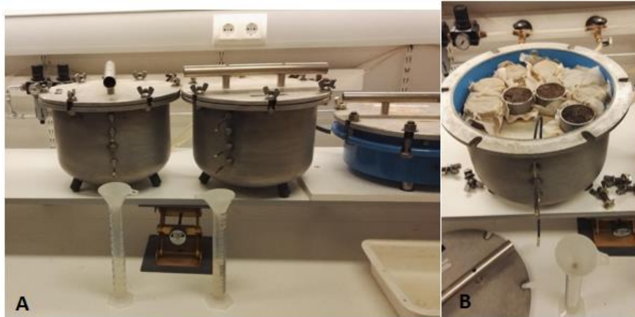
Figur 31: Trykkammer (A) og jordprøver plassert på keramiske plater koblet via et rør til trykkammer (B).
