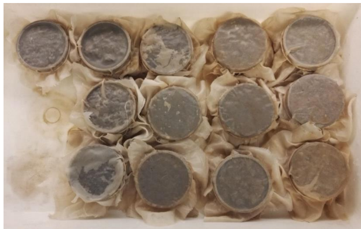
Figur 29: Jordprøver som er vannmettet og klare for veiing. Prøvene dekkes med gassbind for å unngå tap av finstoff ved vannmetningsprosessen.
