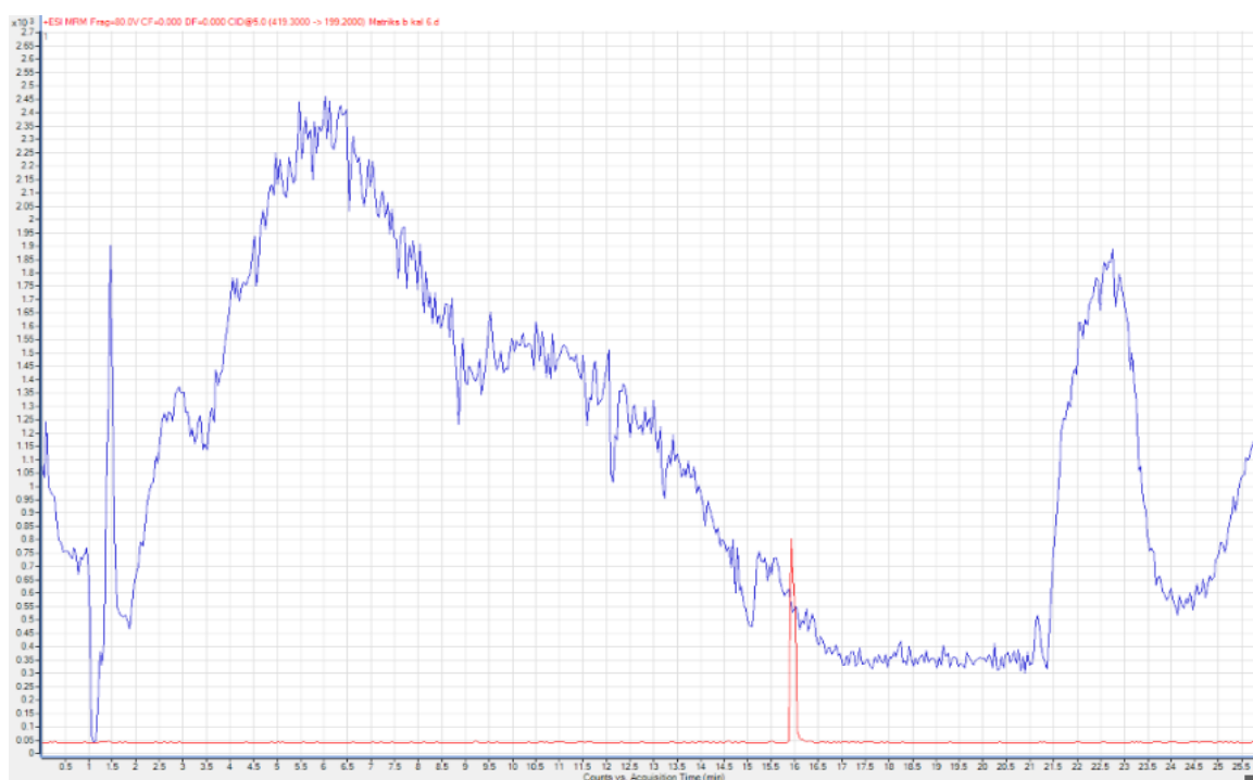
Figur 4-27 Kromatogrammet opparbeidet under ionesuppresjonstesten av simvastatin sitt kvantifiseringsion 285.2 mot matriksblind M-prøve.
