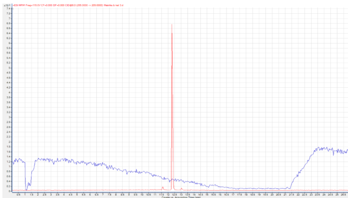
Figur 4-15 Kromatogrammet opparbeidet under ionesuppresjonstesten av ketoprofen sitt kvantifiseringsion 209 med matriksblind M-prøve.
