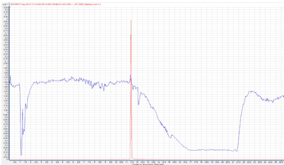
Figur 4-19 Kromatogrammet opparbeidet ved ionesuppresjonstest med losartan sitt kvantifiseringsion 207.2 mot matriksblind M-prøve
