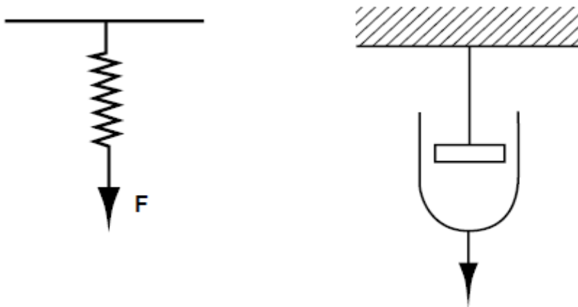
Figur 2-9 Illustrasjon av en elastisk model (Hooke's lov) til venstre, og en viskøs model (Newtons lov) til høyre
