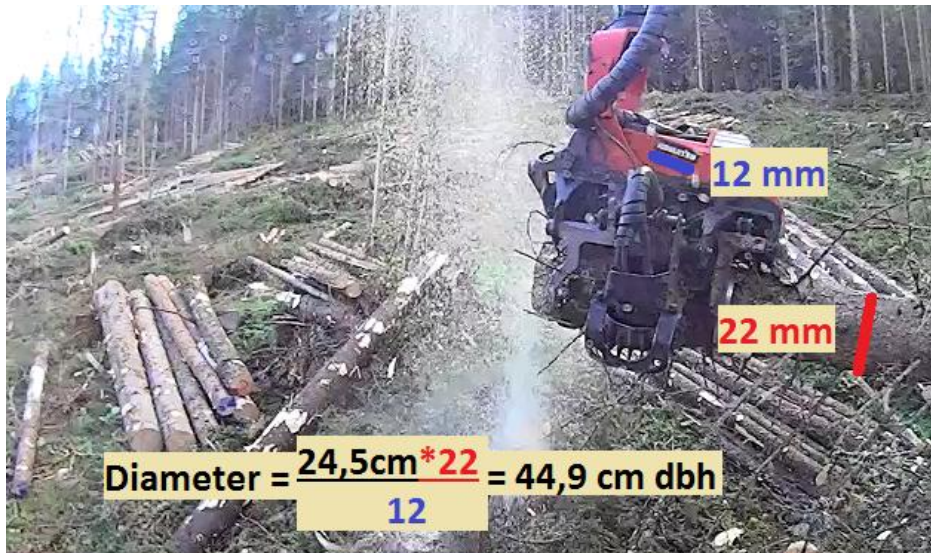
Figur 5 Beregning av diameter fra videoen. I dette tilfellet er "komatsu" -merket 12 mm langt og stammen er 22 mm bred. Forholdet mellom disse størrelsene gir en diameter på 44,9 cm dbh. Forøvrig det største treet i undersøkelsen.
