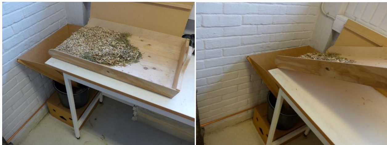
Figur 19: Skuffene fra soldemaskinen blir vendt over dette trebrettet for å minske svinn. Brettet helles over en trakt med bøtten under. Etterpå veies bøtten (fotografi: kandidaten).
