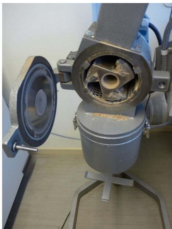
Figur 21: Kvern med 4 mm gitter. Det samles opp mye spon og det er viktig med god rengjøring (fotoграфи: kandidaten).
