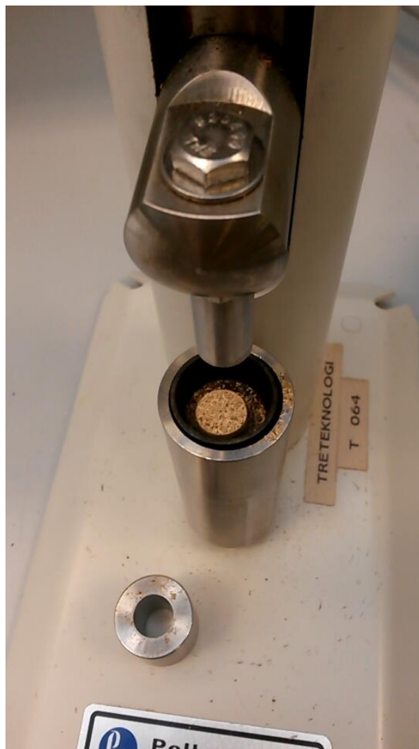
Figur 22: Pelletspresse med ferdigpresset pellets (fotografi: kandidaten).
