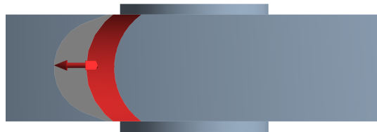
Figur 7.10: Resulterende impuls kraft er påsatt blad i tangential retning.
