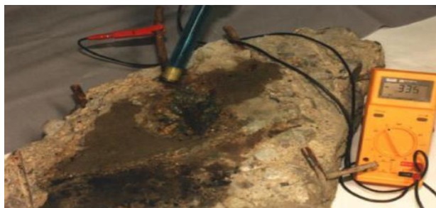
Figur 29: Potensiemålinger med kobber-kobbersulfat-halvcelle utført i laboratoriet. [20]
