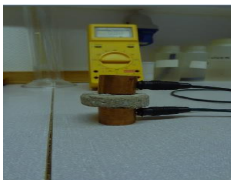
Figur 31: Måling av elektrisk motstand. [20]
