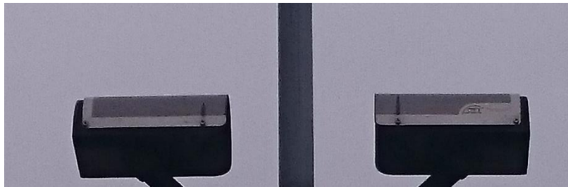
Figur 2.4.1: OTT Parsivel PWS lokalisert ved E18 Holstad. De ulike dekslene beskytter en lasersensor og en mottakerdiode.
