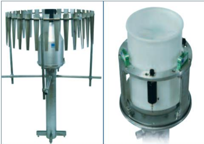
Figur 2.6.1: Geonor T-200B nedbørmengdeinstrument. Målebøtte befinner seg inne sylinderformet beholder, som beskyttes for vind av metallflappene i bildet til venstre. Frekvensmåleren er sort objekt i bildet til høyre. Bilde er hentet fra (GenorA/S).
