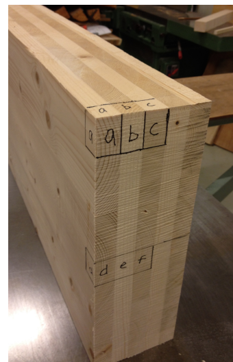
Figur 17: Bildet viser de seks prøvestykkene, nummerert a-f, som ble skåret ut av hver bjelke for registrering av densitet og fuktinnhold
