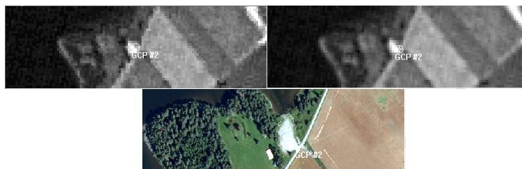
Figur 32 GCP #2 i SPOT-opptak og i referansebildet. For kontroll av geometri.
