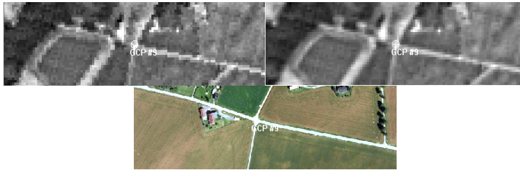
Figur 39 GCP #9 i SPOT-opptak og i referansebildet. For kontroll av geometri.
