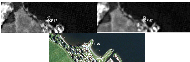
Figur 37 GCP #7 i SPOT-opptak og i referansebildet. For kontroll av geometri.
