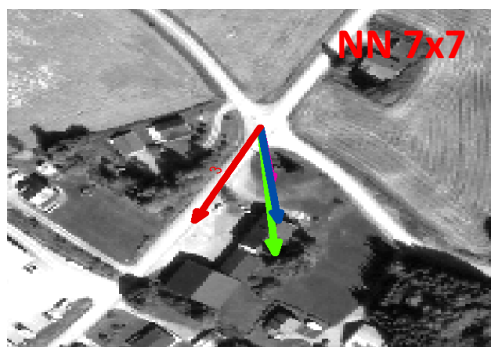
Figur 45 Kontrollpunkt #2 med feilvektorer
