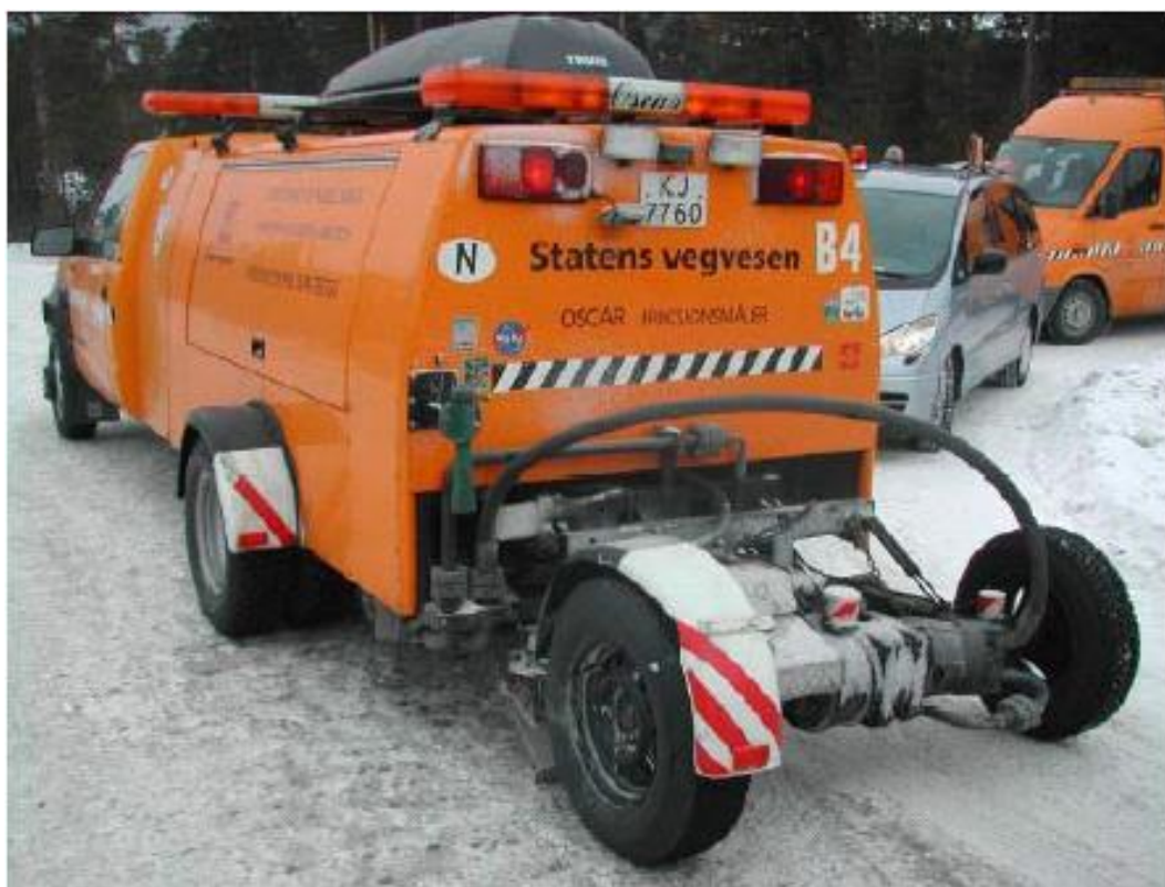
Figur 11 Friksjonsmåleren Oscar i aksjon [6].
