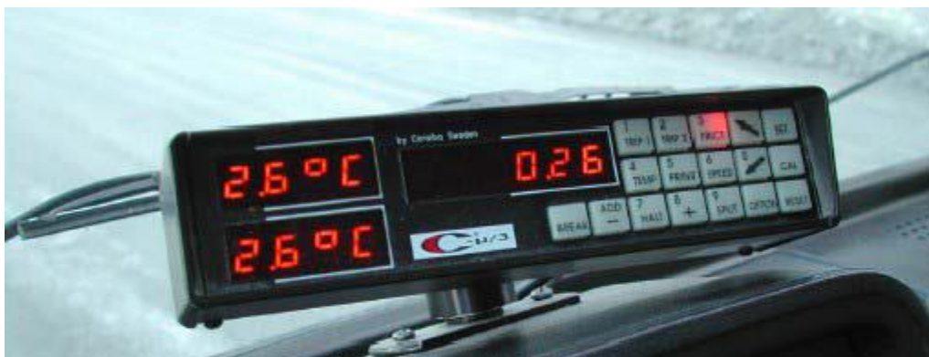
Figur 10 Den mest brukte retardasjonsmåleren i Norge, my C [6].
