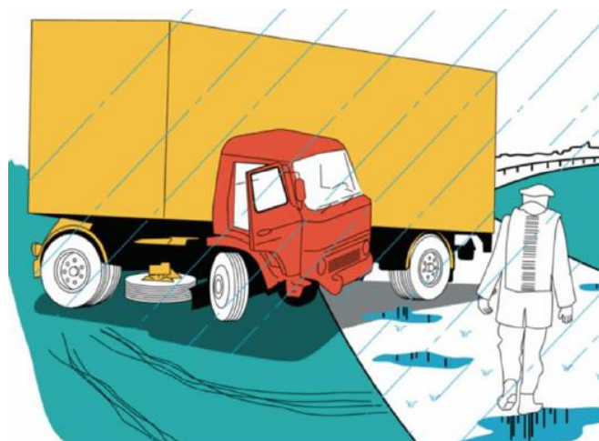
Figur 9 Lastebil som har "jack knifet" på underlag med splitt friksjon [1].
