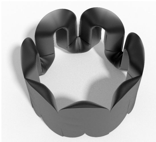
Figur 75: Tettingsring når den er pakket sammen i kateter.
