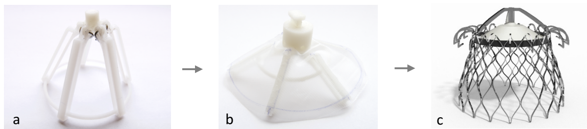
Figur 83: a) Strukturen til prototypen, b) Prototype med duk, c) Utarbeidet designforslag med stent (eget foto).
