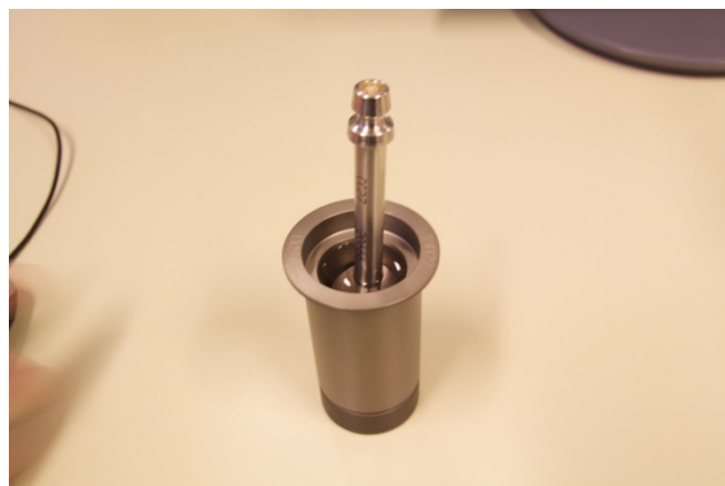
Figur V15: 20 ml løsning ble helt i denne beholderen som settes i rehometeret.
