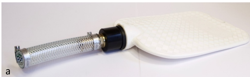
Figur V8: Varmeflaske som fungerer som pumpe(a) og stuss for å feste varmemflaske til slange(b).
