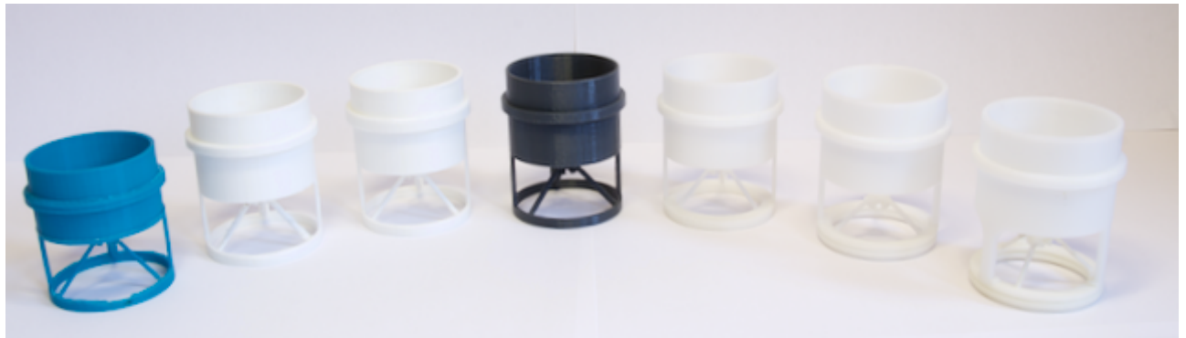
Figur V12: Alle versjonene av muffen som ble laget før den endelige utformingen ble bestemt.
