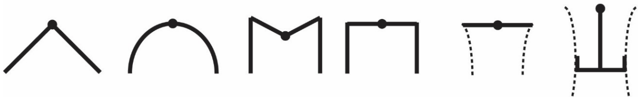
Figur 51: Alternative utforminger på rammen, stiplede linjer illustrer en nettingstruktur.
