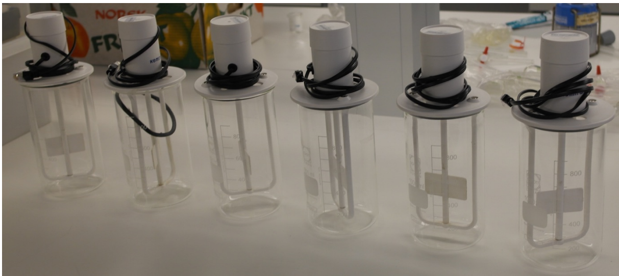
Figur 3-5: Beger til jar-test med tilhørende røreverk. (Foto: Gunhild Nersten)
