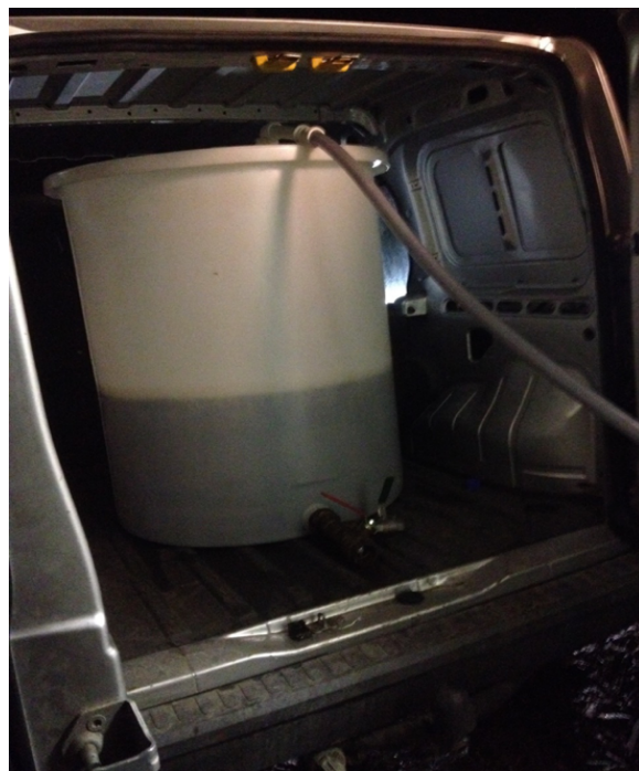
Figur 3-4: Tunnelvaskevann ble pumpet over til en 500 L beholder. (Foto: Arve Heistad)
