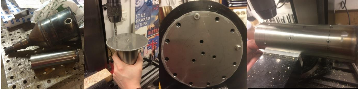
Figur 3.16 Maskinering av flammerør og bakplate i brennkammeret
