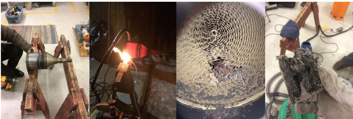
Figur 3.14 Test av katalytisk brennkammer og bilder av oppbrent katalysator.
