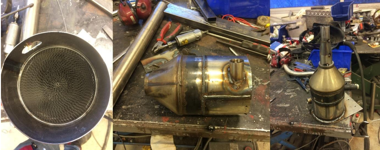
Figur 3.13 Konstruksjon av katalytisk brennkammer med radially luftinntak for å sikre at en uniform gjennomstrømning i substratet.
