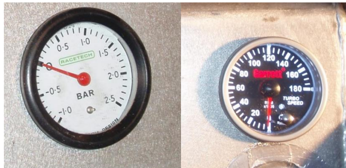
Figur 4.3 Analogt RaceTech Manometer montert på kontrollpanelet til gassturbin. Og Garrett turteller via induktiv måler i kompressorhuset.
