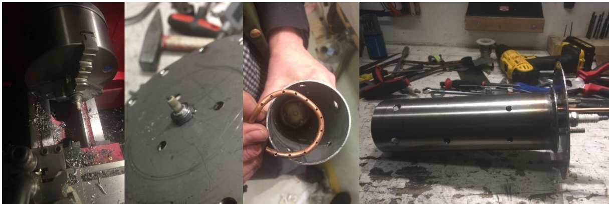
Figur 3.17 Modifisering av tennplugg for enkel tenning med propantilførsel gjennom perforert kobberør. Komplette flammerør ses i bildet T.H
