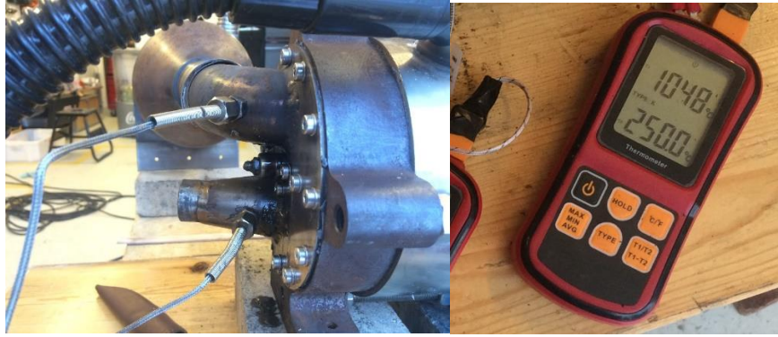
Figur 4.2 Tilkobling av K elementer på varmeveksler. Benetech GM1312, instrumentet har to innganger og kan avlese J, K, T, E, N, R og S elementer med 1,5% nøyaktighet.
