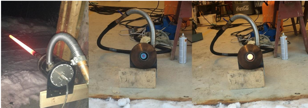
Figur 3.18 Utprøving av brennkammer. Det kan observeres at flammen er sentrert i flammerøret og ikke berører ytterveggene i flammerøret.
