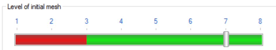
Figur 7. Finheten i meshet rangeres fra 1-8 i SolidWorks flow simulation.
