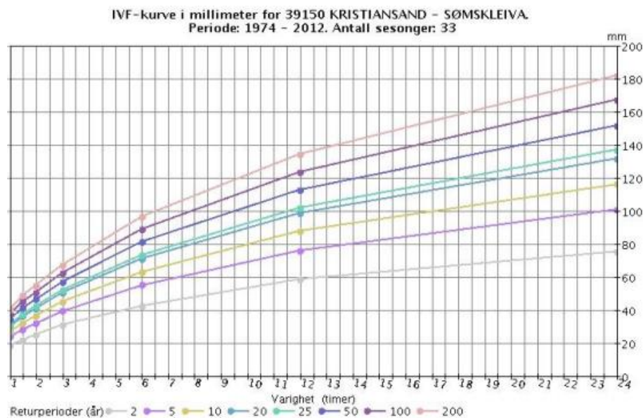
Figur 3-6 - IVF-kurve som viser regnintensiteten i perioden 1974-2012 i mm. Varighet fra 1-24 timer. Kurven er generert på klimaservicesenter.no
