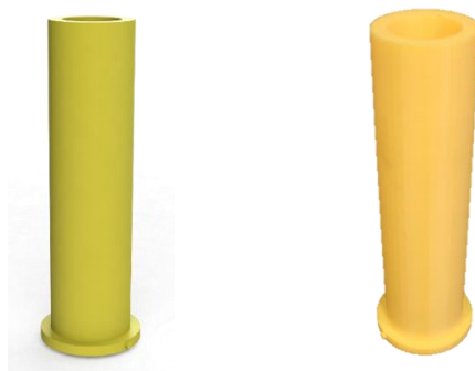
Figur 47: Til venstre illustreres 3D-modellen av forlengelsesrøret. Til høyre illustreres printet resultat av forlengelsesrøret.
