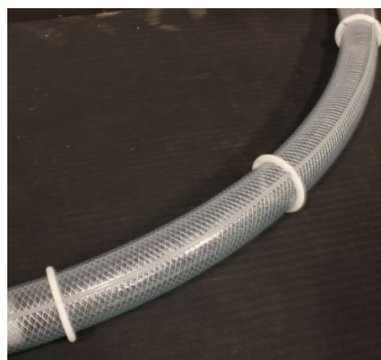
Figur 63: Tre mellomvegger påsatt den indre slangen.
