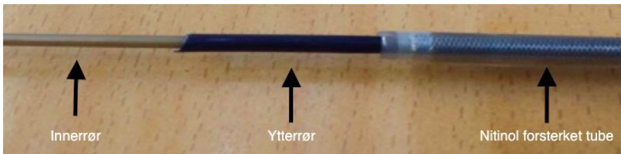
Figur 39: Utdelt hjertekateter som ble demontert.
