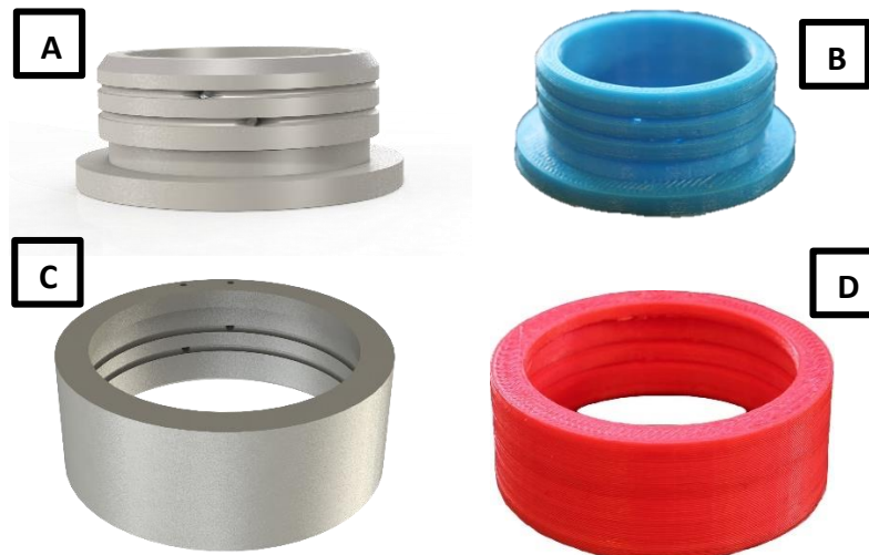
Figur 42: A) 3D modell av indre rotasjonsdel. B) Printet indre rotasjonsdel. C) 3D modell av ytre rotasjonsdel. D) Printet ytre rotasjonsdel.
