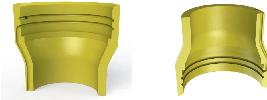
Figur 78: Snittet 3D-modell av den ytre rotasjonsdelen fra to perspektiv.
