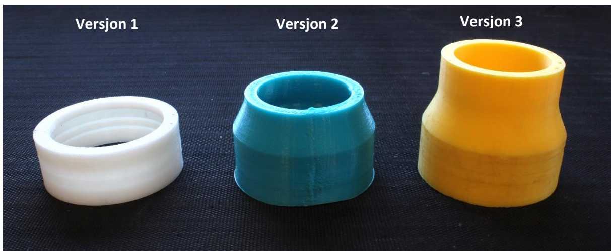
Figur 44: 3D-printede rotasjonsdeler og dens utvikling gjennom sammensetningen av prototypen.
