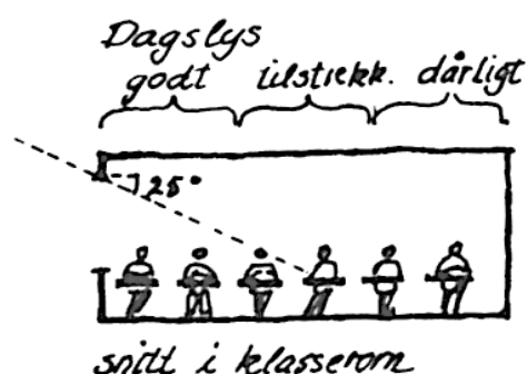
Figur 2-4 - Illustrerer brukbart dagslys i rom med 7-8 m dybde Kilde: (Brantenberg, 1980).
