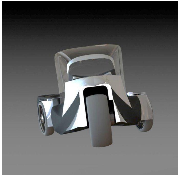
Figur 14.7 Illustrert dempesystemet som kan krenge i svinger, sett bakfra.
