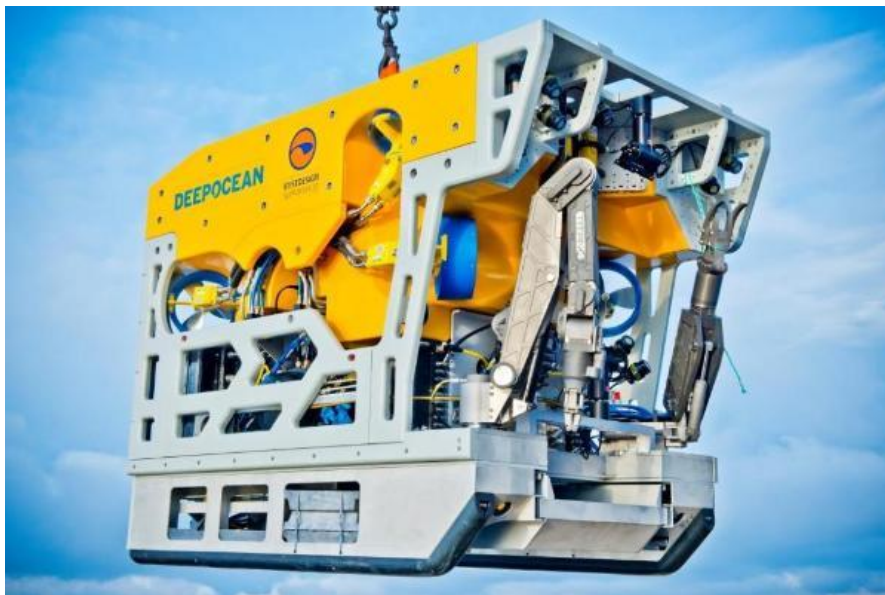
Figur 17: Eksempel på ROV fra kystdesign der metoden i dag består av å styre enten en høytrykksspyler eller en børste med en av manipulatorene [24]
