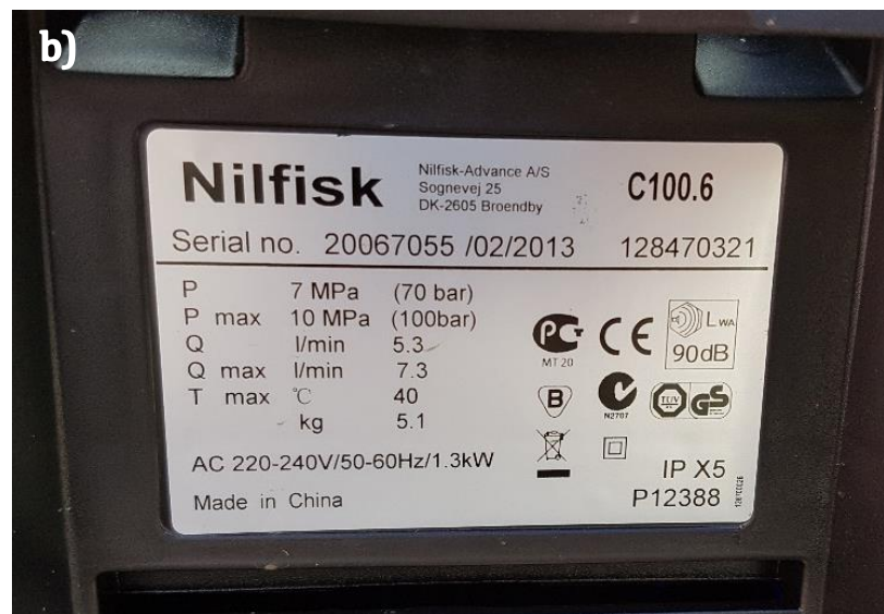
Figur 25: Høytrykksspyler. a) Nilfisk C100.6 b) Teknisk data (Egne foto)
