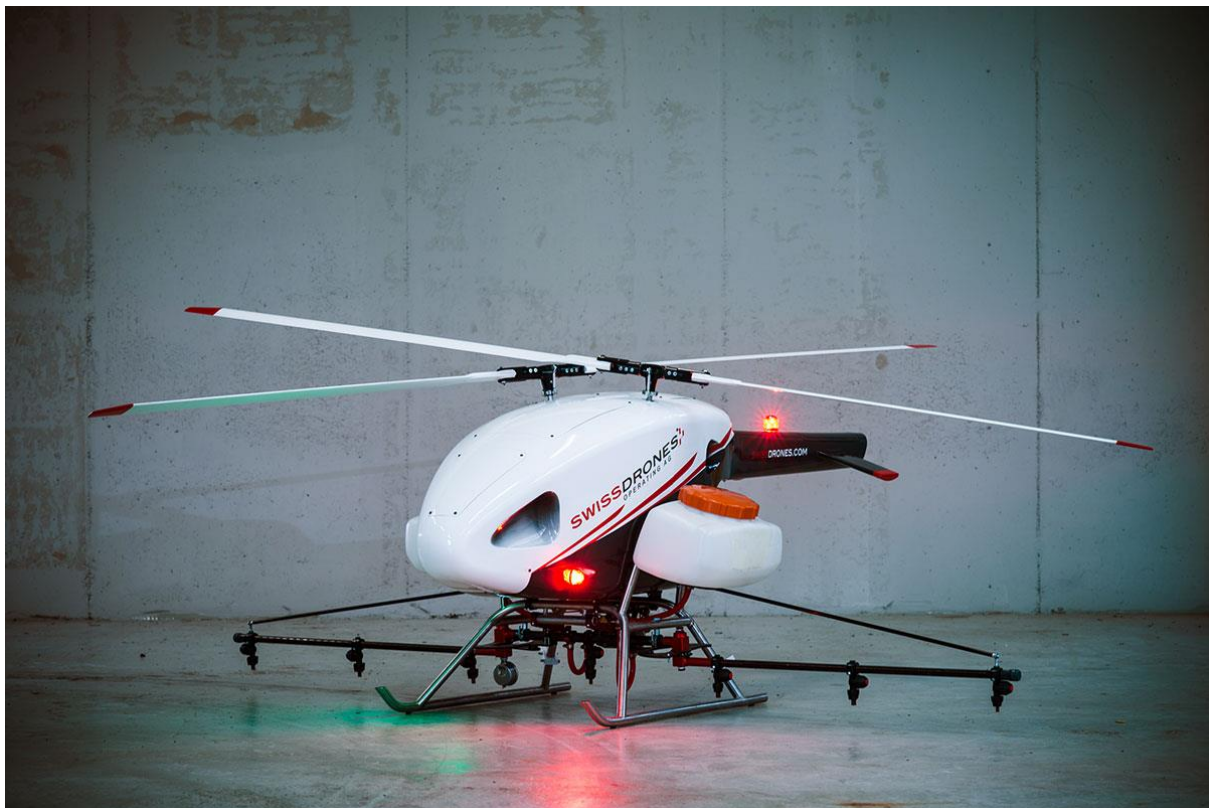
Figur 16: SwissDrones SDO 50V2. Dieseldrevet drone med en nyttelast på 50 kg. [23]
