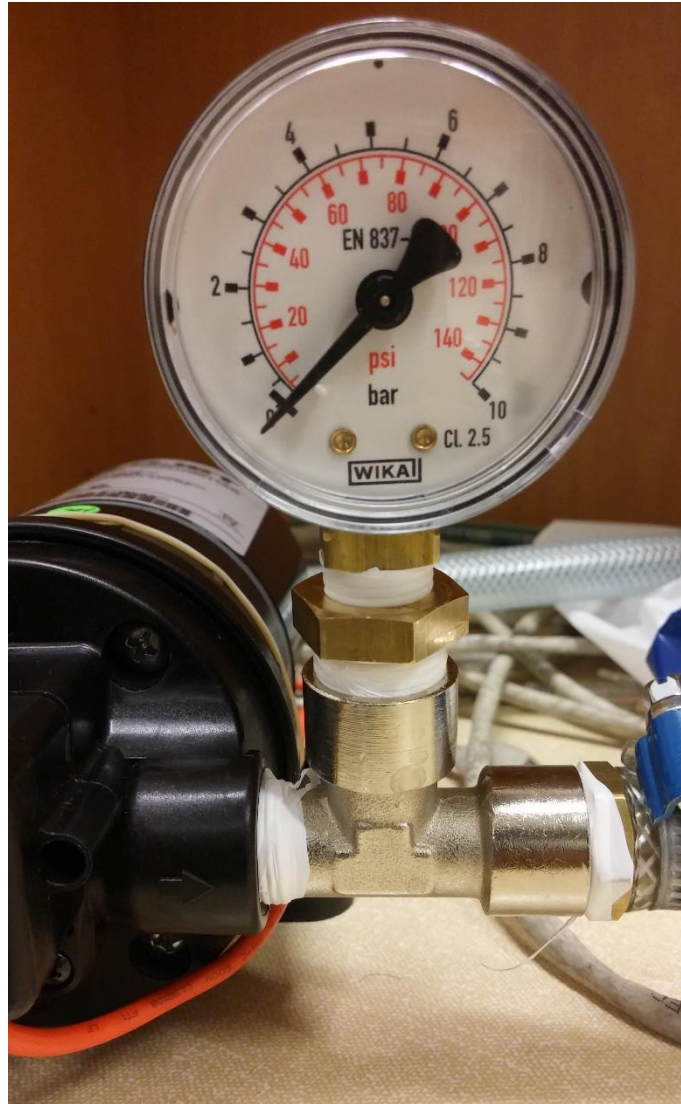
Figur 7.1: Pumpe, t-stykke, overgang og manometer
