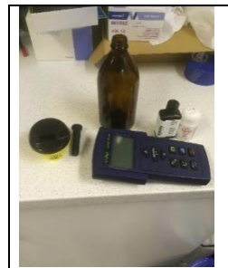
Figur 14: vise utstyre brukt til BOF5 analyser Foto: Honar A. Said
