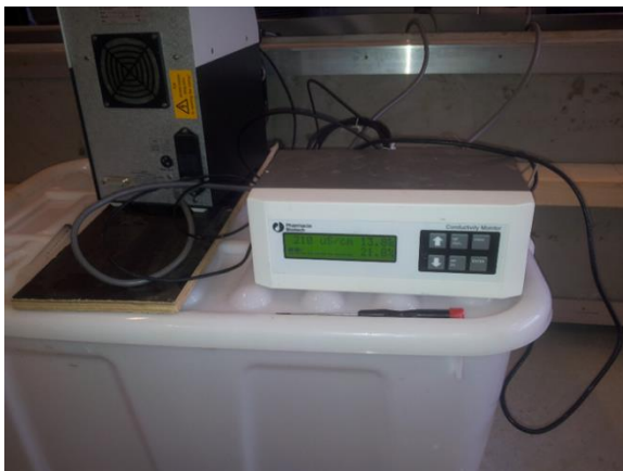
Figur 7: Til venstre viser konduktivitet måleren (Pharmacia Biotech) til den andre Peristaltiske pumpe for pumpe opp prøvevann til den Konduktivitet måleren til høyre Foto: Honar A. Said
