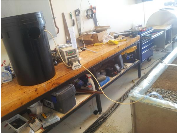
Figur 6: viser den peristaltiske pumpen med seks innganger, og plastbøtteløsningen som inneholdt av 29,5 liter grunnvann og 29,5 liter behandlet gråvann og en liter rågråvann og 30 ml bakteriofager salmonella Typhimurium fager 28B(S.t.28B)
