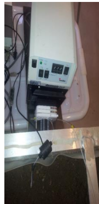
Figur 7: Til venstre viser konduktivitet måleren (Pharmacia Biotech) til den andre Peristaltiske pumpe for pumpe opp prøvevann til den Konduktivitet måleren til høyre Foto: Honar A. Said
