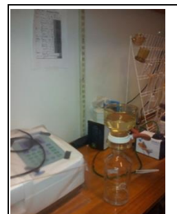
Figur 13: vise utstyre brukt til TSS analyser Foto: Honar A. Said
