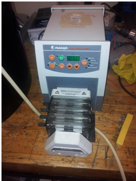
Figur 5: Peristaltiske pumpe for å frakte miksløsningen til forsøksrennerens innløpet Foto: Honar A. Said
