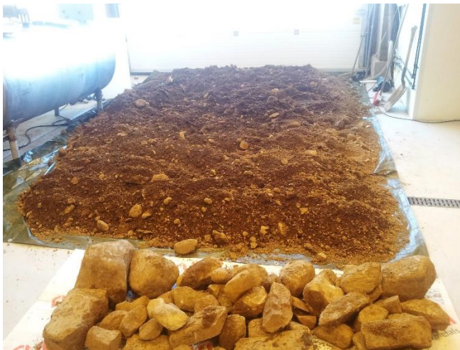
Figur 8: Til venstre viser morenejord fra Ås kommune i Norge som ble bruk i forsøket. Til høyre er pukken som ble benyttet foran i innløpet og utløpet (11/22 mm) fra Franzefoss Pukk, avd. Vinterbro Foto: Honar A. Said
