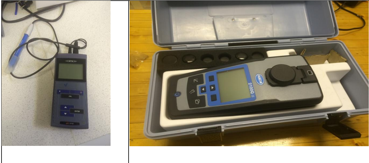
Figur 12: Til venstre vise pH meter og til høyre fotospektrometere for turbiditetsmåling. Foto: Honar A. Said
