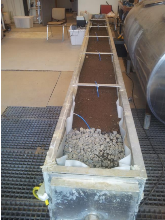
Figur 4: Viser to bilder av forsøk oppsettet(rennen). Med innløpet og utløpet og forskjellige prøvepunktene. Foto: Honar A. Said
