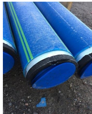
Figur 2.1: 180 PE100 SDR11 rør med PP-kappe og diff.sperre.
