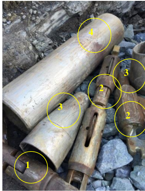
Figur 4.5: Skjærekniv og blokkerhodet.
