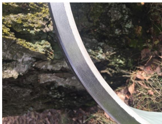
Figur 4.2: DN400 støpejernsrør sprøytet med 2 x 3,3 mm FLP.
