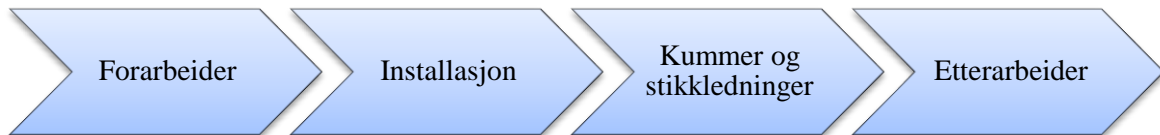
Figur 4.6: Prosessrekkefølgen i et ledningsreoveringsprosjekt.
